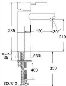
**Starre hohe Einhebel-Selbstschluß WT-Mischarmatur\* DN15, mit elektronisch gesteuerter berührungsloser Sensorautomatic; integrierter voreinstellbarer Fließmengen- u. Temperaturregelung, mit Hebel und Verstellenschutzkappe; 2-Step-Eco-Kartusche; Strahlregler; Magnetventile mit VS-Adaptor;**
