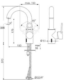
**Schwenk-Einhebel-Selbstschluß WT-Mischarmatur\* DN15, mit elektronisch gesteuerter berührungsloser Sensorautomatic; integrierter Fließmengen- u. Temperaturregelung, mit Hebel und Verstellenschutzkappe; 2-Step-Eco-Kartusche; Strahlregler; Magnetventile mit VS-Adaptor, 2 Flexschläuche ca.350x3/8\"/>**
