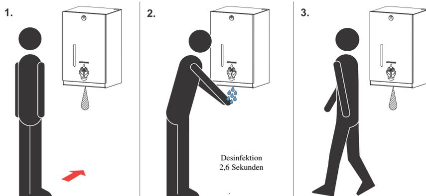
**Funktion Standard** - voreingestellte Abgabezeit 2,6 Sekunden, entspricht Abgabemenge von 1,0 ml pro Dash.
