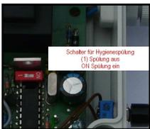
Die Electronic (Eingang 230VAC, Betriebsspannung 24VDC) wird mit ausgeschalteter Hygienespülautomatik ausgeliefert:
