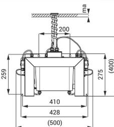
Mehrplatz Edelstahl-Sensor-Wandseifenspender(UP); 2 - 6 Plätze, Peristaltische Pumpe pro Platz, 6 Ltr. Seifentank; Füllstandsleuchte, integrierter 24V-Trafo. Seifenzuleitungsschlauch bis max. 2500 mm Entfernung Seifenspender zu Pumpentankeinheit.
