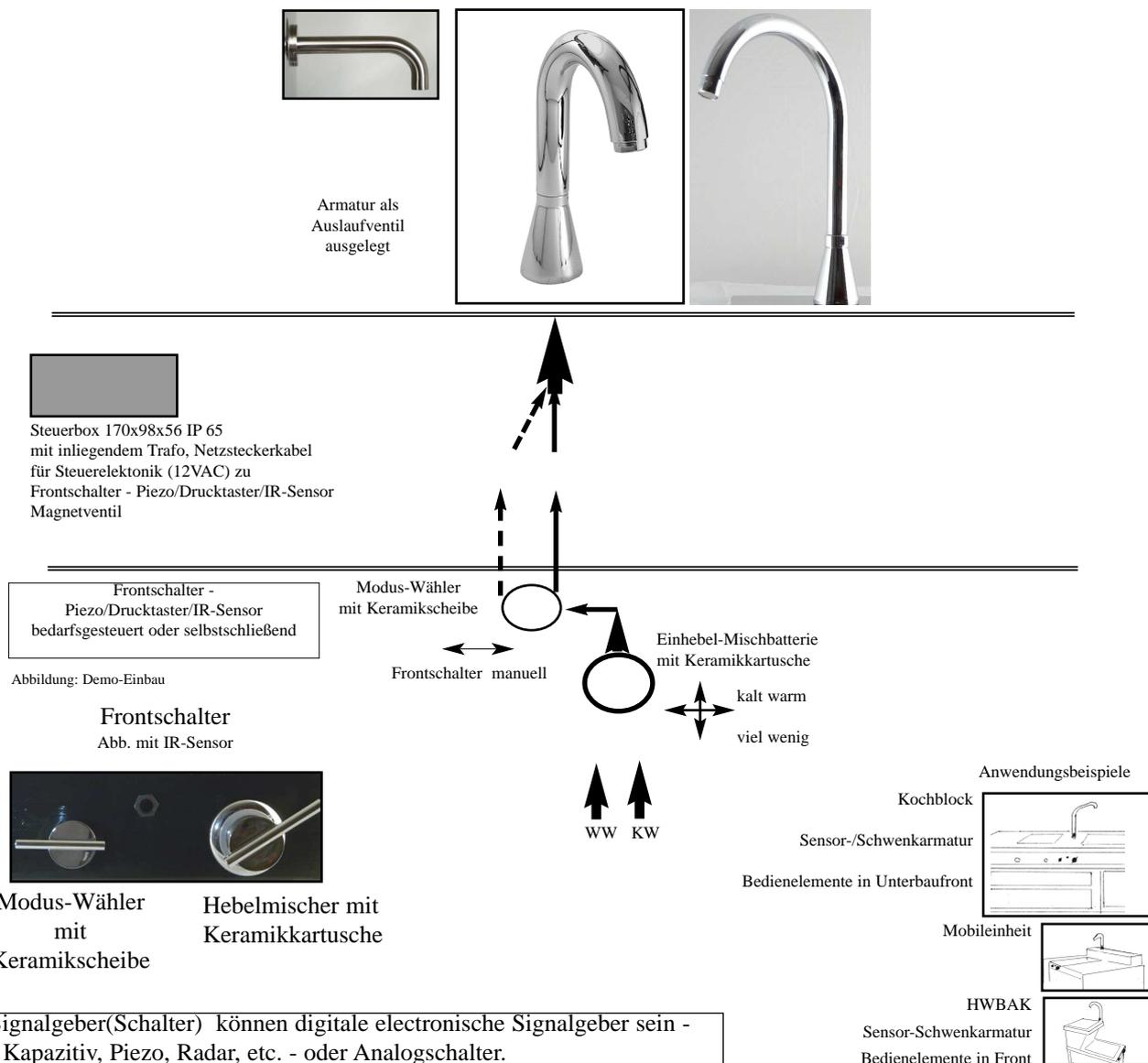
\* Die Signalgeber(Schalter) können digitale elektronische Signalgeber sein - Opto, Kapazitiv, Piezo, Radar, etc. - oder Anlogschalter. Die Anbringung richtet sich nach den Gegebenheiten.
