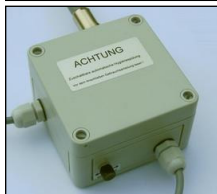
Steuerbox mit integriertem Netzteil in IP65 98Bx98Hx56Tmm
